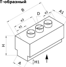
Адаптер П-образный с верхним присоединением воздуховодов
